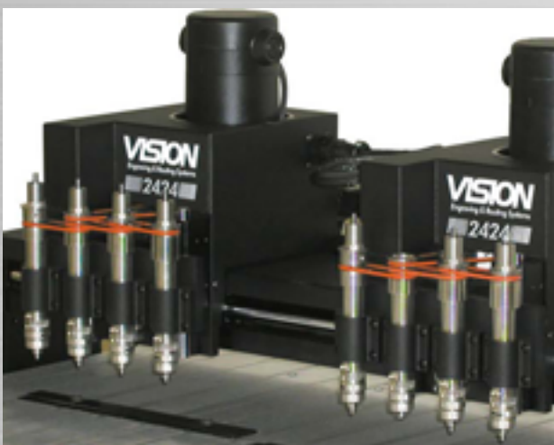
Vision 2424 mit 2 Z-Achsen und je 4 Spindeln für die Mehrfach-Gravur mit Fräser oder Burnisher
