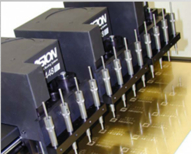
Vision 2448 mit mehreren Z-Achsen und Ritzeinheiten für Ritzgravur von vielen gleichen Schildern
